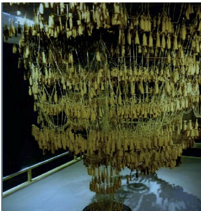
*Figura. 2 – Il modello per la simulazione degli sforzi nella Basilica della Sagrada Família di Gaudì (foto di M.G. Lorenzi, da [14])*
